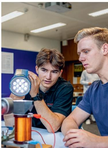
Tüfteln und Entdecken – die Lernenden messen die Drehzahl des Rotors eines Gleichstrommotors mit Hilfe eines Stroboskops. Früher waren Stroboskope in der breiten Masse als «Zauberscheiben» bekannt.
